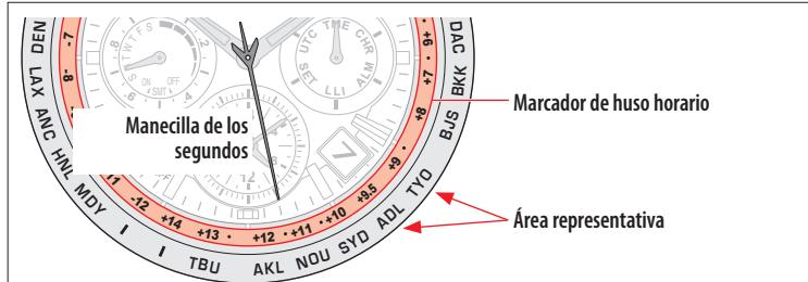
En la ilustración, la manecilla de los segundos señala 28 segundos y el ajuste del huso horario es «+11,5».
