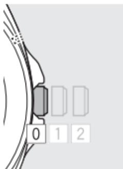
**7 Presione la corona hasta la posición  0 para finalizar el procedimiento.**
