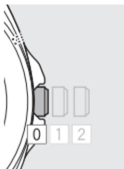
**3 Cuando las manecillas y la indicación se detengan, presione la corona hasta la posición 0 para finalizar el procedimiento.**
