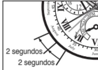
Cargue el reloj haciendo que la luz incida sobre la celda solar hasta que el reloj comience a funcionar. En el caso de que el reloj se haya parado como resultado de estar con una carga insuficiente, se requiere un mínimo de 30 minutos hasta que el reloj comience a funcionar nuevamente, aun si la luz incide sobre la celda solar. Cargue suficientemente el reloj haciendo referencia a la parte titulada "11. Referencia general para los tiempos de carga"
