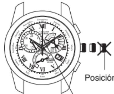
Cuando la corona es extraída demasiado a la posición 2, la manecilla de segundos se mueve a la posición de 0 segundos y se para, y el reloj ingresa en el modo de corrección.
