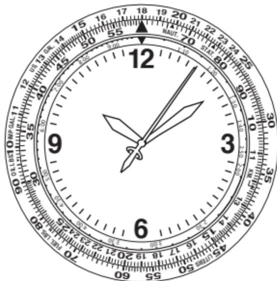
**Nota:** in alcuni modelli, il regolo interno e quello esterno sono invertiti. Assicurarsi di applicare le sostituzioni appropriate alle istruzioni che seguono.
