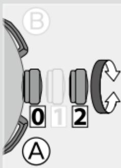
**6 Faites pivoter la couronne pour régler l'aiguille ou l'indication.**
